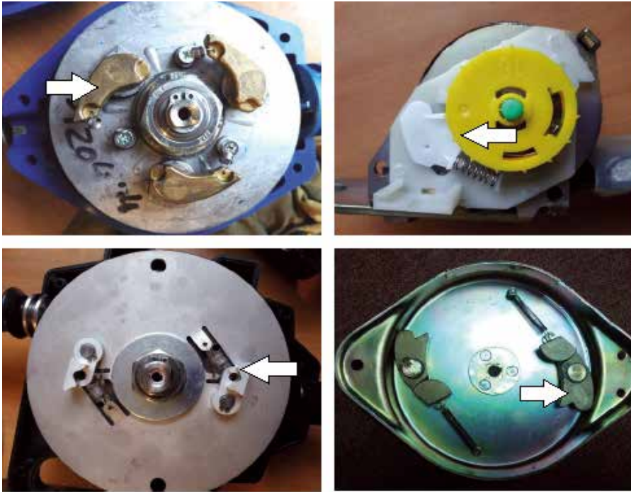
Rys. 1. Przykłady różnych konstrukcji mechanizmów blokujących w urządzeniach samohamownych. Strzałkami zaznaczono zapadki blokujące (fot. Marcin Jachowicz) Fig. 1. Examples of various designs of locking mechanisms in retractable type fall arresters. Arrows indicate the locking pawls (photo: Marcin Jachowicz)
