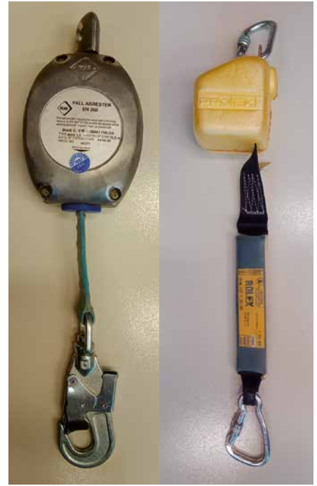
Rys. 3. Widok urządzenia samohamownego wyposażonego w taśmę włókienniczą: bez amortyzatora włókienniczego (po lewej) i z amortyzatorem włókienniczym (po prawej) (fot. Marcin Jachowicz) Fig. 3. View of the retractable type fall arrester equipped with a textile tape: without textile shock absorber (left) and with textile shock absorber (right) (photo: Marcin Jachowicz)
