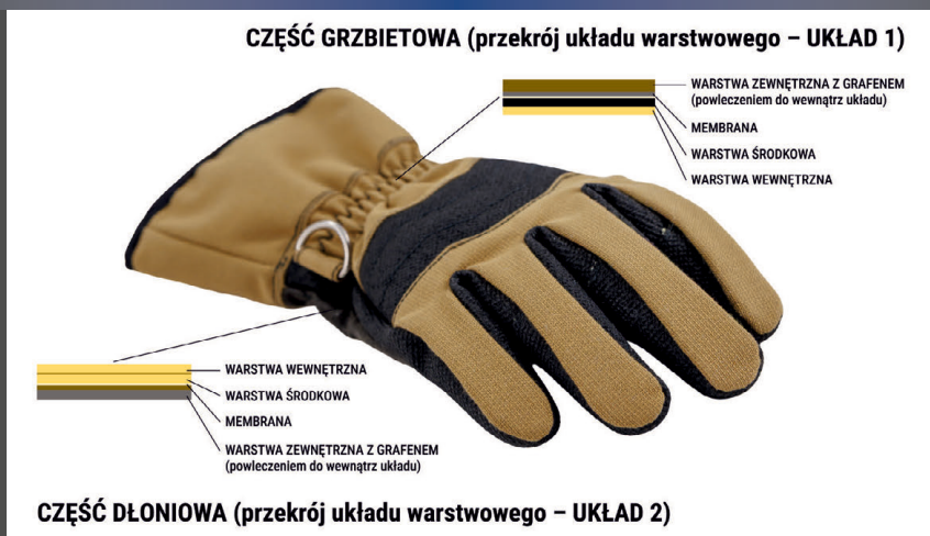
Rys. Konstrukcja rękawicy grafenowej dla strażaków
