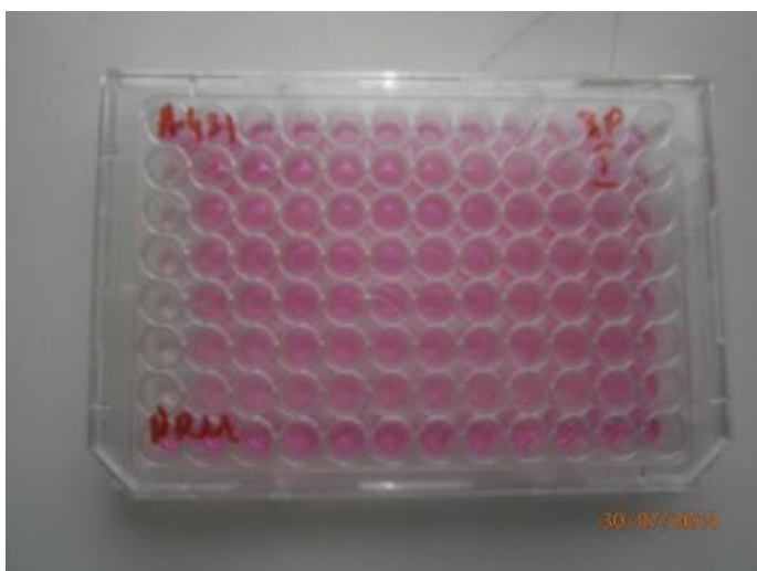
Rys. 10. Badania nad cytotoksycznym działaniem biopaliw metodami in vitro na płytkach 96-dółkowych (fot. CIOP-PIB)
