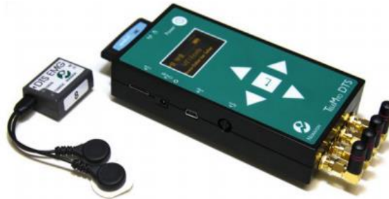
Rys.16. System Noraxon TeleMyo™ 2400T (DTS) wraz z jednym czujnikiem i podłączonymi elektrodami odbiorczymi
