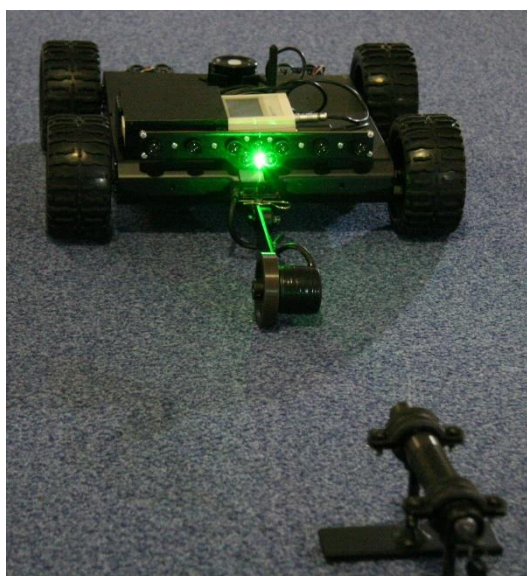
Rys. 9.4. Widok kołowej platformy mobilnej od strony tylnej - z zamontowanymi kolimatorami i enkoderem
