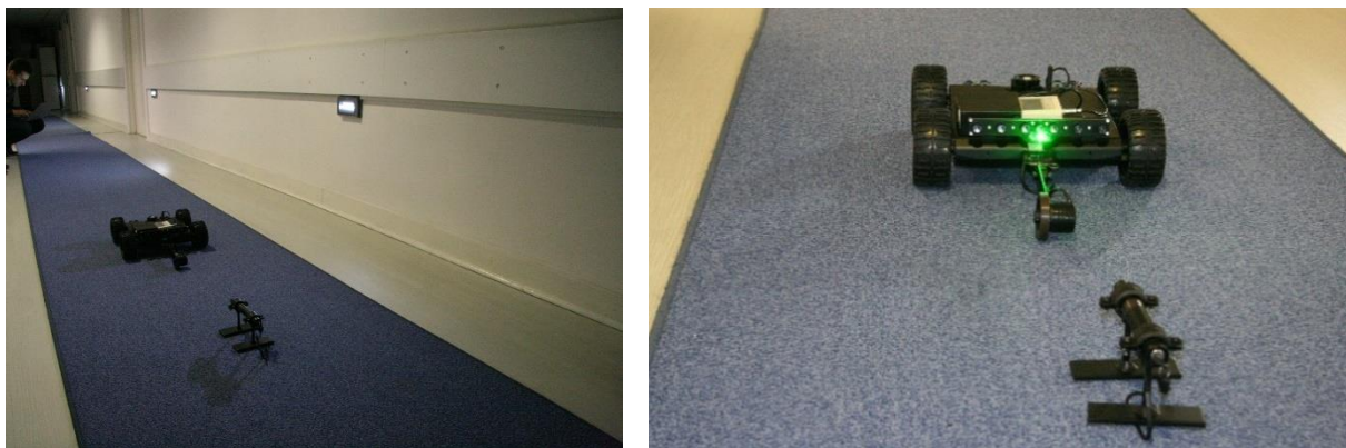
Rys. 9.5. Widok korytarza podczas wykonywania pomiarów natężenia oświetlenia ewakuacyjnego z wykorzystaniem modelu urządzenia pomiarowego
